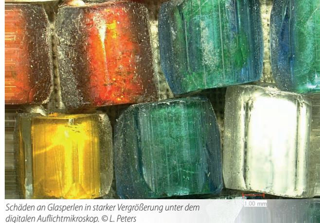
Schäden an Glasperlen in starker Vergrößerung unter dem digitalen Auflichtmikroskop. © L. Peters
