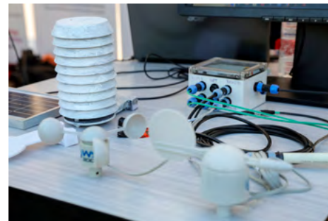
Angepasst: Eine kostengünstige Wetterstation zum Einsatz in Entwicklungsländern – entwickelt am Institut für Technologie und Ressourcenmanagement in den Tropen und Subtropen.
