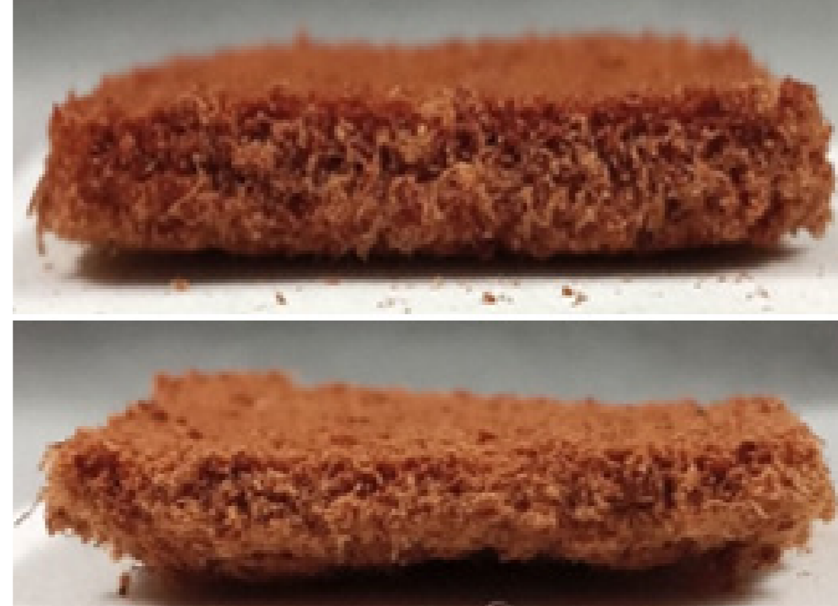
Abb. 2: Untersuchung durch Gravimetrie am Faserprobekörper; oben: Klucel E in Butan-1-ol, unten: mit Klucel G in Butan-1-ol. © Schatz
