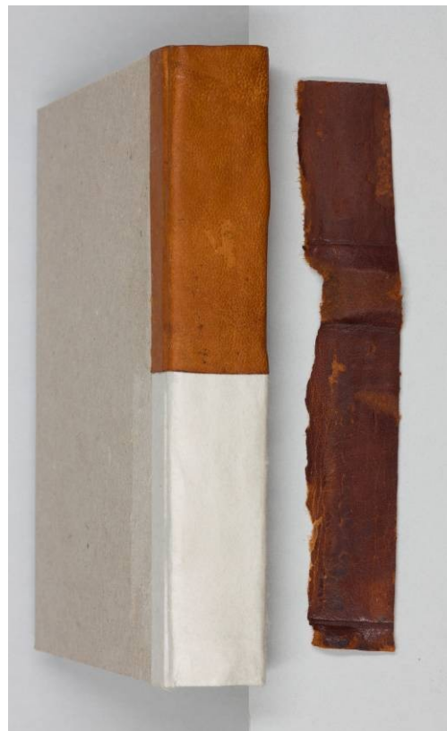
Abbildung 31: Das Probenleder dunkelt durch den Auftrag des Festigungsmittels auf der Narbenseite temporär
