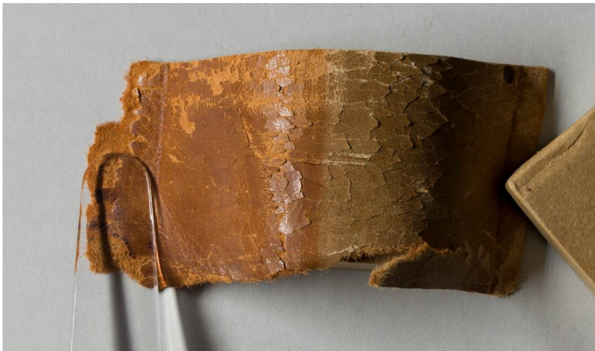
Abbildung 11: Sich durch Biegung abhebende Schollen der Narbenschicht, hier dargestellt mit der Referenzprobe 8 nach der Lichtalterung
