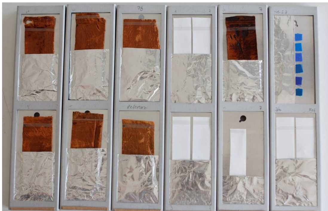
Abbildung 25: Für die Lichtalterung wurden die in den Probenhaltern montierten Lederproben, die Filterpapiere und die Blauwollstandard-Typen zur Hälfte mit Aluminiumfolie abgedeckt
