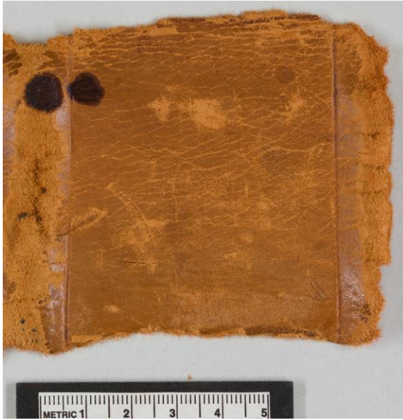
Abbildung 12: Verhalten des Probenleders nach Auftrag eines Wassertropfens, Auflichtfotografie
