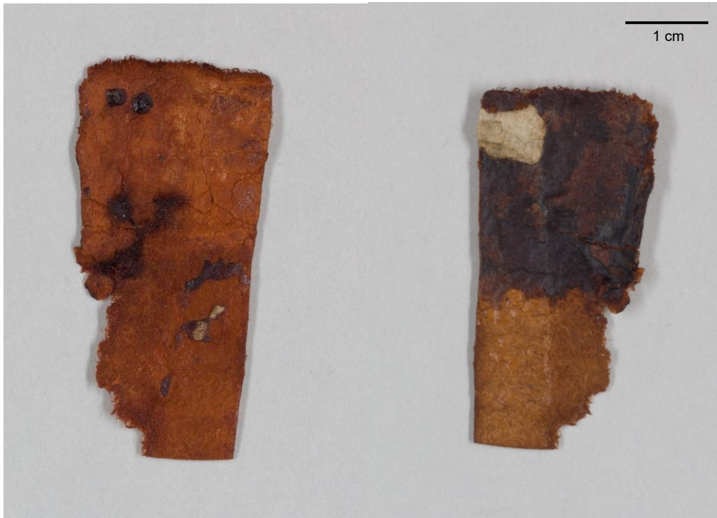
Abbildung 29: Historische Lederprobe, die zur weiteren Untersuchung beidseitig mit Klucel® G, 10 % in Butanol behandelt wurde. Die Fleischseite (rechte Abbildung) wurde in der oberen Hälfte mit Weizenstärkekleister bestrichen. Die Abbildung zeigt die Probe nach der Trocknung. Der Kleister hat Schwärzungen verursacht, die bis auf die Narbenseite durchgedrungen sind (linke Abbildung).
