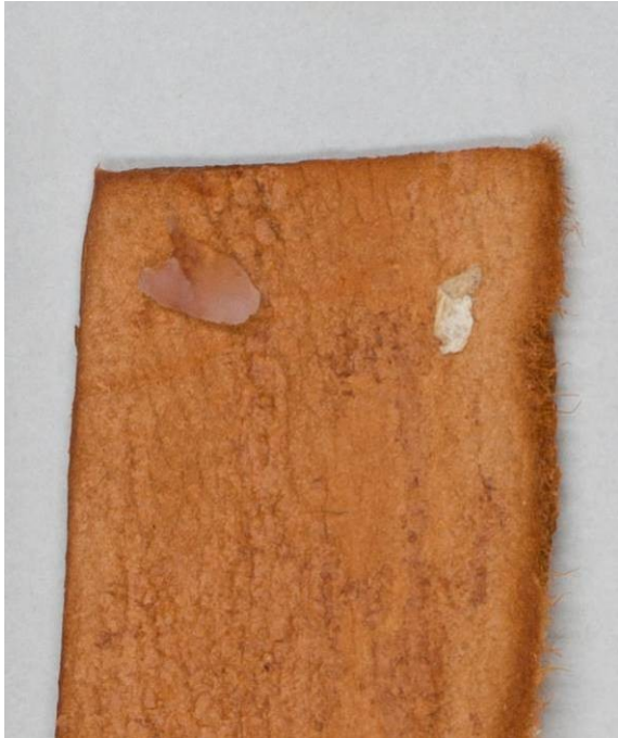
Abbildung 34: Aufgetragener Weizenstärkekleister links oben zur Prüfung der Wasserempfindlichkeit
