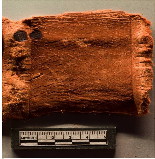
Abbildung 13: Starke Reaktion des Probenleders auf Wassereintrag, Streiflicht von links
